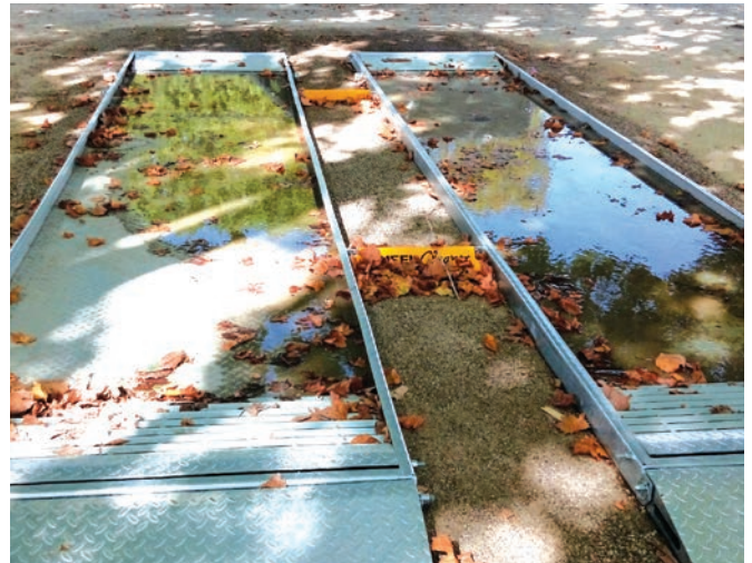
PÉDILUVE MOBILE EN ENTRÉE DE CHANTIER (SOURCE : POUSSE CONSEIL)
