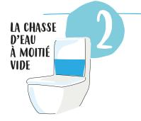
Une chasse d'eau à double commande permet de diminuer la consommation d'eau de plusieurs litres à chaque remplissage de la cuvette (une chasse d'eau classique consomme entre 6 et 12 litres d'eau, une double commande 3 à 6 litres).
